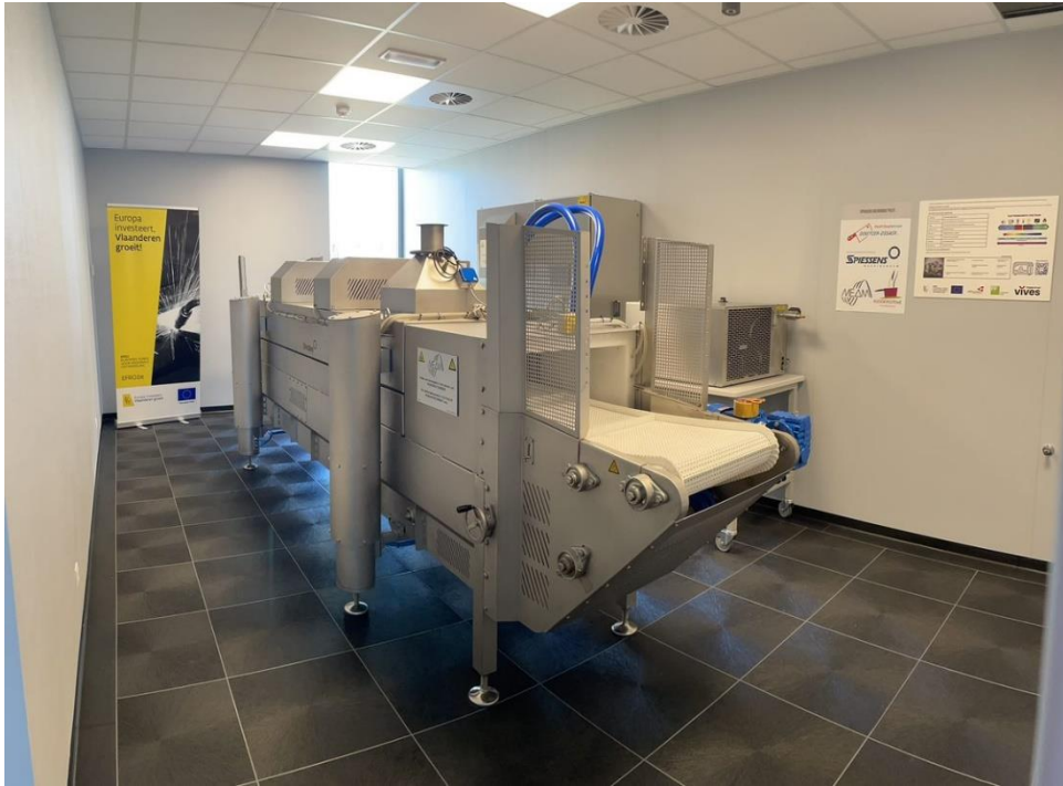
In-line microgolfoven van de Microwave Pilot waarop het pilootonderzoek zal uitgevoerd worden.
