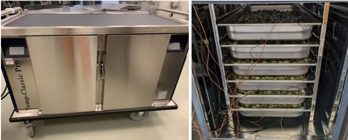
Figuur 9: Regeneratiekar voor het regenereren en het warmhouden van de groenten.
